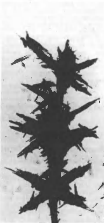
При замещении кварцем марганцевого кальцита образуются игольчатые кристаллы гидроокислов марганца, ориентированные по кристаллографическим направлениям марганцевого кальцита [увел. в 50 тыс. раз].
